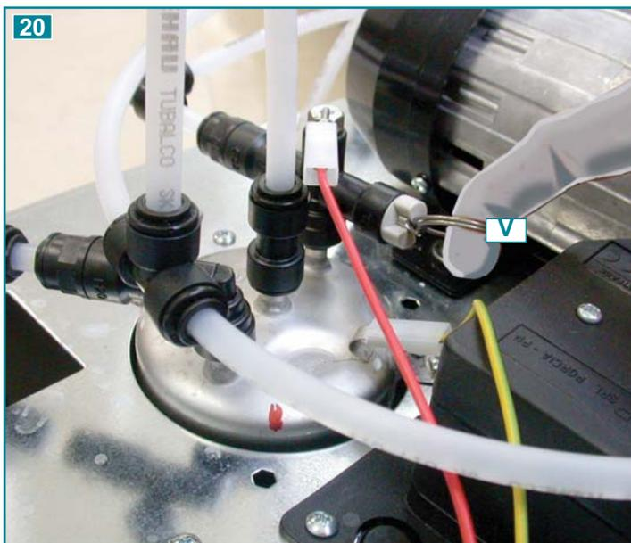
Prima di aprire la macchina per effettuare una manutenzione, spegnerla, scollegarla dalla presa di corrente e chiudere la bombola CO<sub>2</sub>. Una volta aperta la macchina, scaricare la pressione del CO<sub>2</sub> tirando la valvola di sfiato V.
